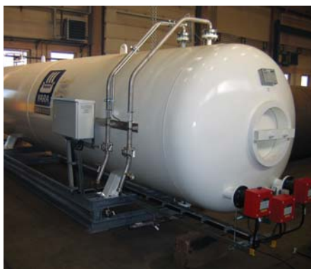
Рис. 1. Система CO 2 с резервуаром высокого давления и визуальным отображением на блоке контроллера PLC (цементный завод Akcansa - Canakkale компании Heidelberg Cement в Турции)
