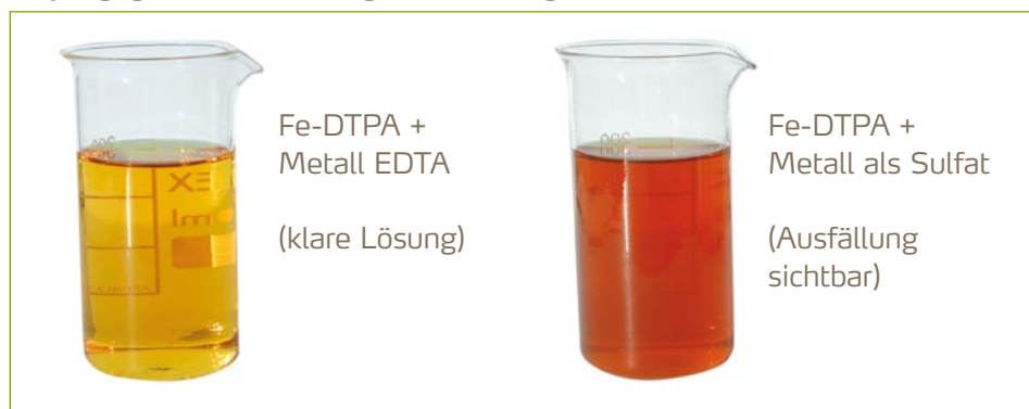
Abb. 5: Ausfällung von Eisenchelate (rechts) wenn andere Metalle als Sulfat gegeben werden (5 g/l Nährlösung)
