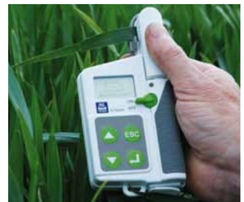
ABBILDUNG 16: Der YARA N-Tester ist ein tragbares Messgerät, mit dem der tatsächliche Stickstoffbedarf von Getreide auf dem Feld ermittelt werden kann.
