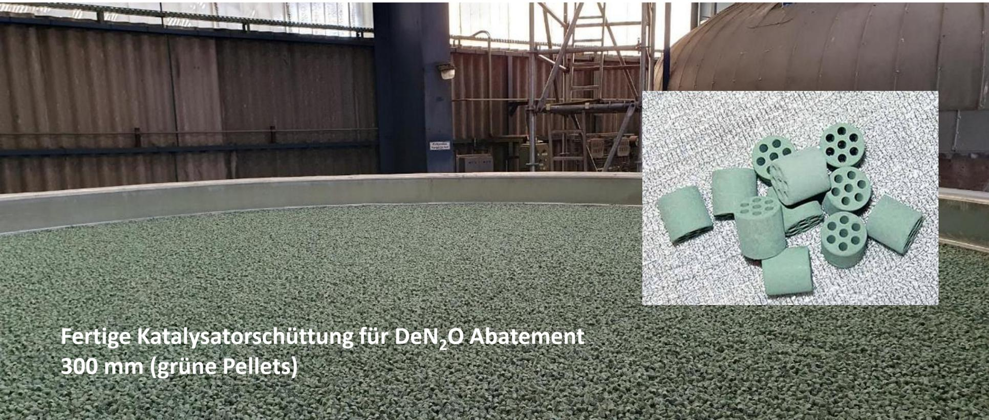
Fertige Katalysatorschüttung für  $\text{DeN}_2\text{O}$  Abatement
