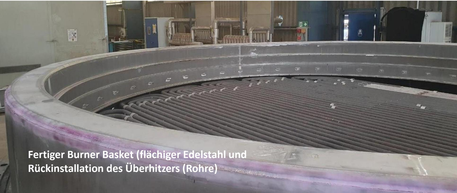
Fertiger Burner Basket (flächiger Edelstahl und Rückinstallation des Überhitzers (Rohre))
